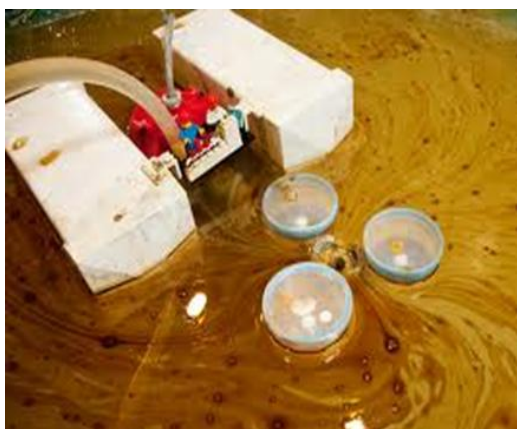
شکل (۲). تخلیه فیلم روغن و کف (فوم) شناور بر سیال توسط اسکیمر
