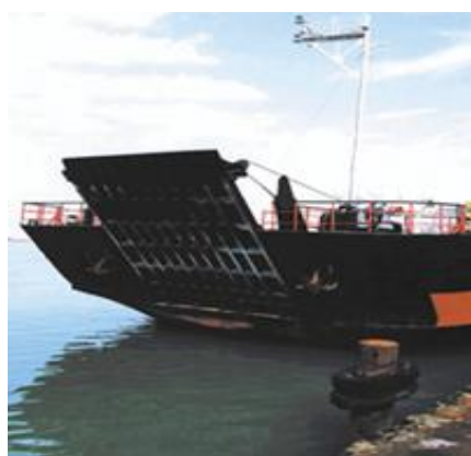
شکل (۲). رمپ نصب‌شده روی بارج مسطح
