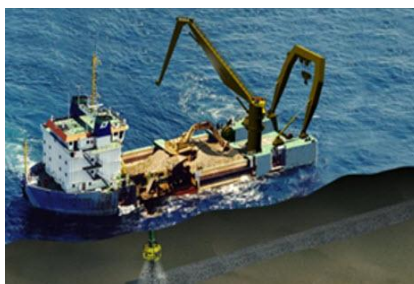
شکل (۱۲). نمایش عمق عملیاتی شناور لوله‌آبشاری و استفاده از آن جهت پوشش روی خطوط لوله [۸]
