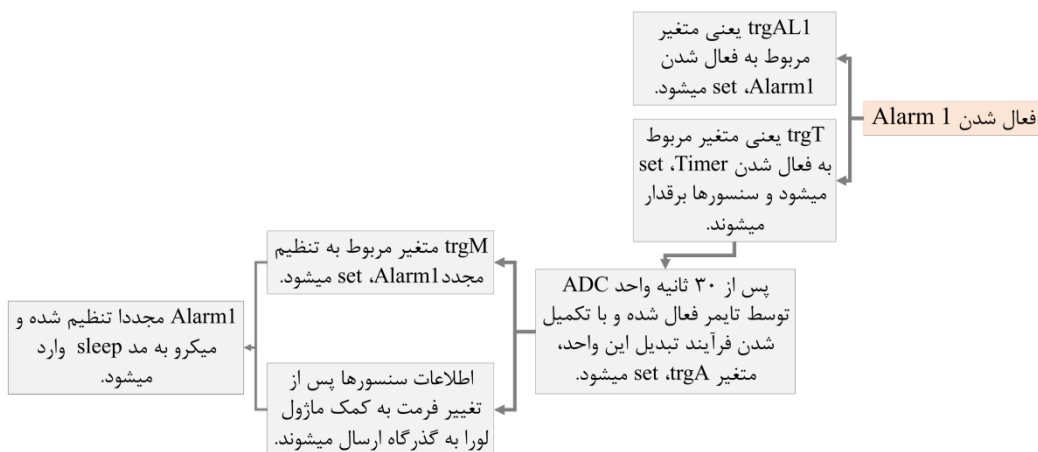
شکل (۸). نحوه عملکرد بخش مرتبط با Alarm1 برنامه میکروکنترلر
