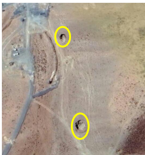
شکل (۱۴). تصویر هوایی از ریزش تونل خوانسار
