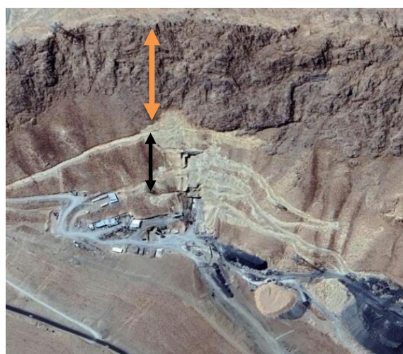
شکل (۸). تشکیلات آهکی (نارنجی) و اسلیتی (سیاه) تونل خوانسار
