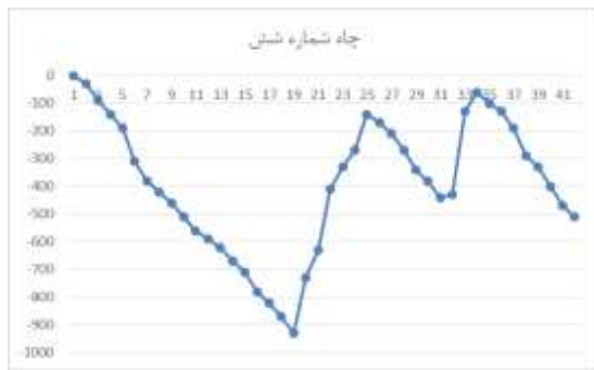
شکل (۸). نمودار تغییرات سطح آب چاه شماره شش. (محور افقی بیانگر زمان از فروردین ۱۳۹۲ تا مهر ۱۳۹۵ و محور عمودی بیانگر تغییرات سطح آب چاه با واحد میلی متر است)
