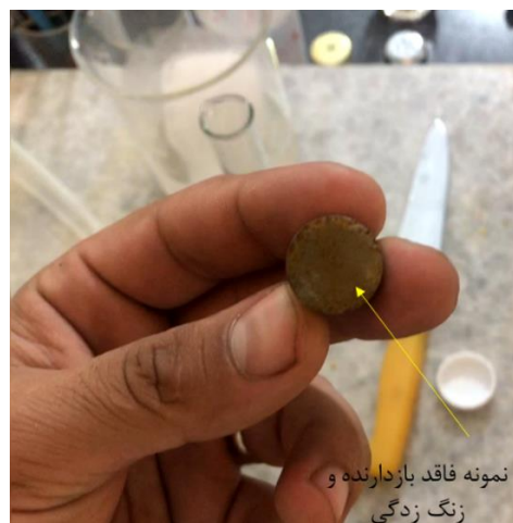
شکل (۴). زنگ زدگی و خوردگی نمونه فاقد بازدارنده
