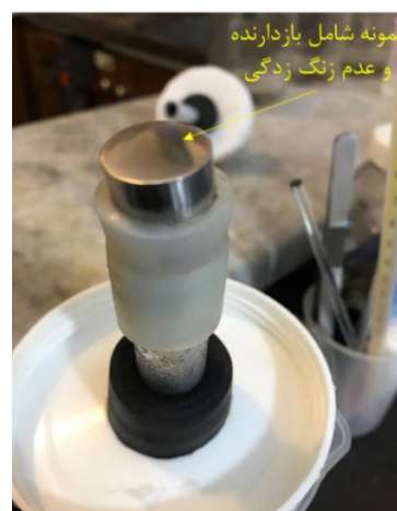
شکل (۵). عدم خوردگی نمونه شامل بازدارنده.
