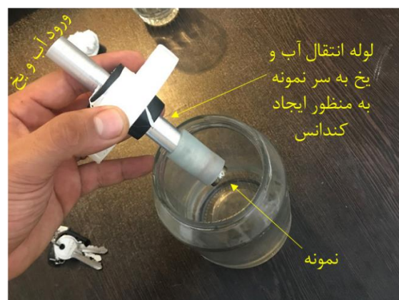
شکل (۲). تجهیزات آماده شده برای تست
