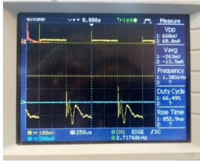
شکل (۸). سیگنال TTL جهت مدولاسیون پالس سیگنال تراهرتز
