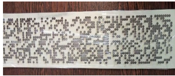
شکل (۳). ماسک مکانیکی ساخته شده با پیکسل‌های دایره‌ای
