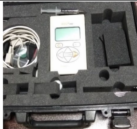
شکل (۶). دستگاه تحلیل گر خواص حرارتی مدل KD2 pro به همراه لوازم همراه
