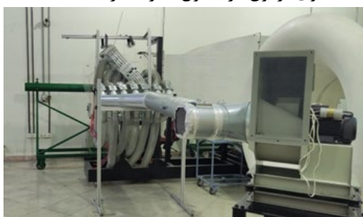
شکل (۲). نمایی از سکوی آزمون کسکید خطی آزمایشگاه دانا به همراه سیستم مکش لایه‌مرزی
