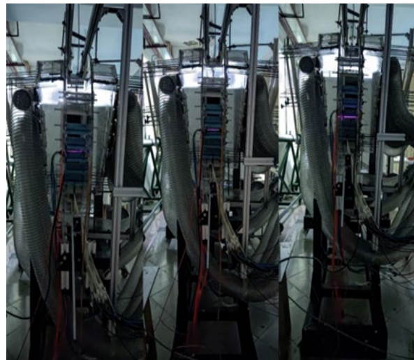
شکل (۲۳): نمای واقعی تشکیل نیروی القایی عملگر پلازما در موقعیت‌های مختلف قرارگیری بر روی پره
