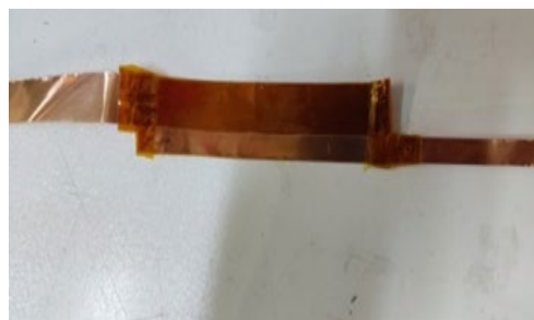
شکل (۱۴): نمای واقعی عملگر DBD مورد استفاده
