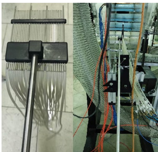
شکل (۸): نمایی از ریک فشاری در حالت نصب روی سکوی کسکید آزمایشگاه دانا دانشگاه صنعتی امیرکبیر
