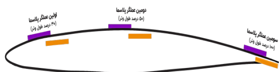
شکل (۱۵): نمایی از نحوه قرارگیری عملگر پلاسما بر روی پره
