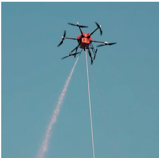
شکل (۲): سامانه پهپادی پاشش سیال استفاده شده برای مطالعه اثرات تغییر شیلنگ، نازل، دبی و فشار
