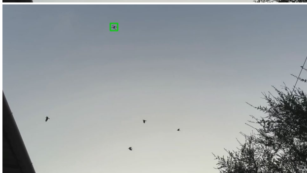
شکل (۱۳): خروجی YOLOv8 در شناسایی ریزپهپاد بر روی فایل ویدئویی مربوط به حالت حضور پرندگان
