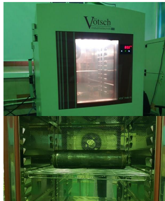
شکل (۵): پوسته استوانه‌ای در داخل محفظه حرارتی.
