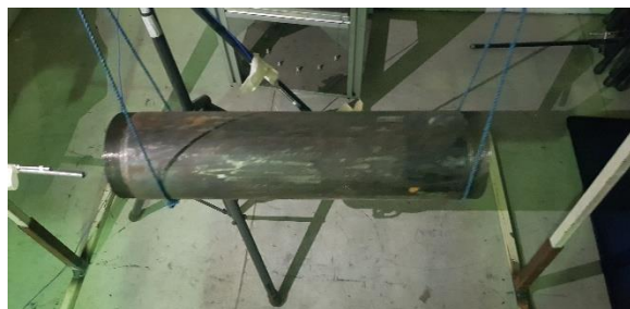
شکل (۱): پوسته استوانه‌ای فولادی ساخته شده.
