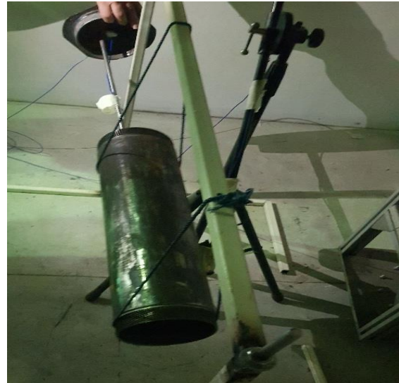
شکل (۴): نحوه قرارگیری میکروفون در داخل پوسته.
