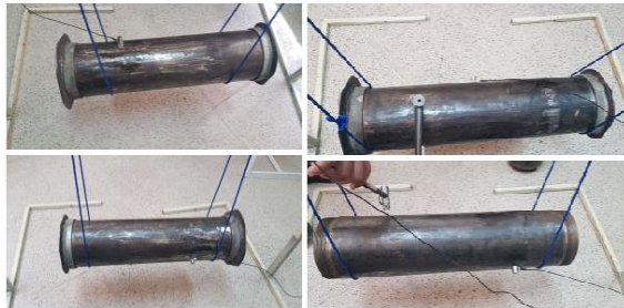
شکل (۶): آزمون چکش مودال روی پوسته استوانه‌ای.
