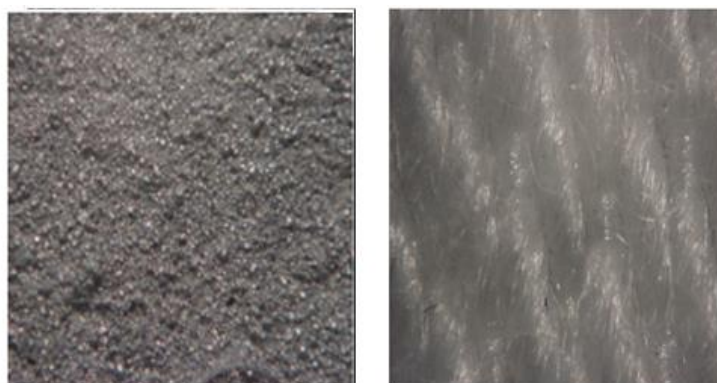
شکل (۳): تصویر میکروسکوپ استریو: نمونه شاهد (سمت راست) و پارچه با پوشش آلومینیوم (سمت چپ)
