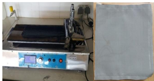
شکل (۲): فرآیند لایه نشانی توسط دستگاه فیلم کش (چپ)، پارچه پوشش داده شده به‌وسیله آلومینیوم (راست)
