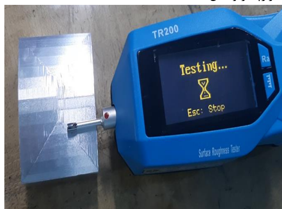
شکل (۲): دستگاه زبری‌سنج مورد استفاده جهت بررسی کیفیت سطحی.
