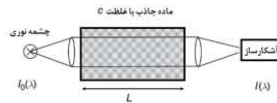
شکل (۱): طرح‌واره بیناب‌نگاری نوری جذب تفاضلی. در این چیدمان نوعی، پرتو نور با شدت I_0(\lambda) از درون یک ماده جاذب با ضخامت L و غلظت C عبور می‌کند و شدت I(\lambda) در آشکارساز ثبت می‌شود.
