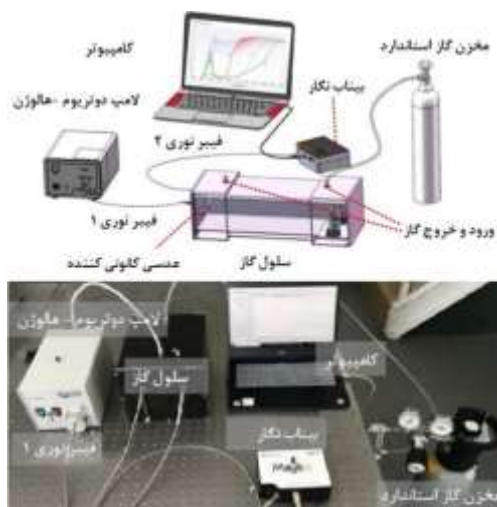
شکل (۶): (بالا) طرح‌واره چیدمان روش DOAS و (پ) تصویری از چیدمان آزمایشگاهی استفاده شده برای بینی‌نمایی گازها.
