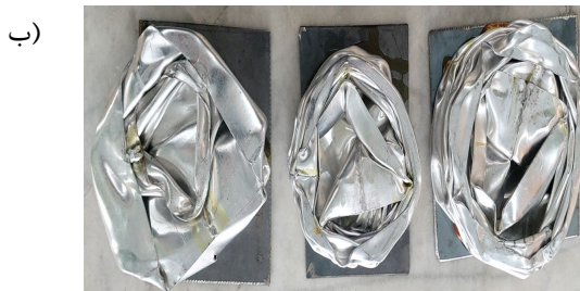
شکل ۱۰: تصاویر له شده هر سه نمونه از نمای بالا (الف) شبیه‌سازی (ب) تجربی
