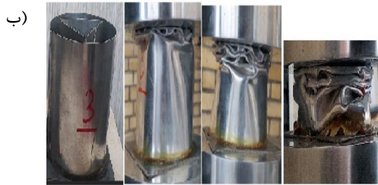
شکل ۹. مراحل لهیدگی محوری پوسته دوجداره دایره‌ای و مثلثی A3
