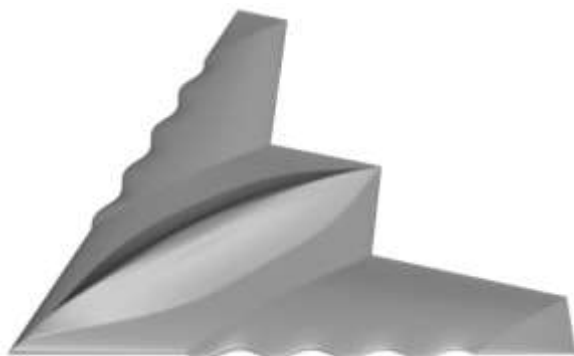
شکل (۷): مدل آزمون با لبه حمله سینوسی
