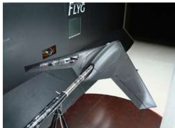
شکل (۶): مدل آزمایش در تونل باد سرعت پایین [۱۰]
