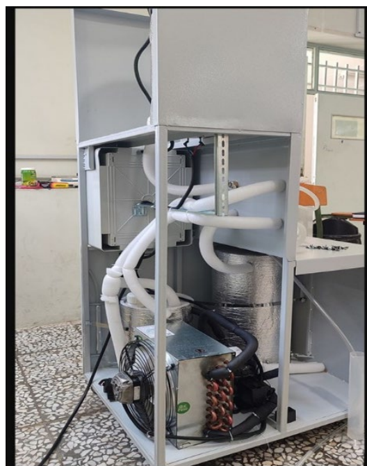
شکل (۳): سیستم آزمایشگاهی تقطیر غشایی با فاصله هوایی
