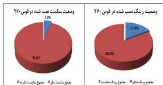
شکل (۱۷). وضعیت کیفیت سگمنت‌ها و رینگ‌های نصب‌شده در قوس ۲۷۰ متر
