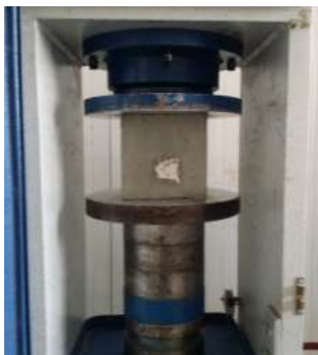
شکل (۱). نمونه تحت آزمایش مقاومت فشاری
