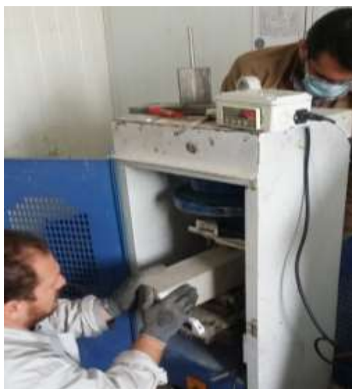
شکل (۲). نمونه تحت آزمایش مقاومت خمشی.
