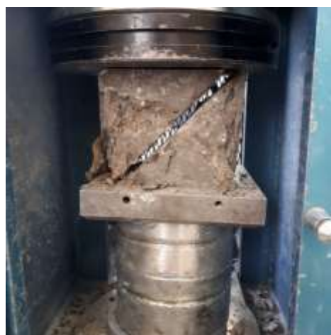
شکل (۱). سنجش مقاومت برشی مورب
