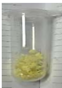
شکل ۶. سوپراکسیدپتاسیم تولید شده با روش گرمایش مقاومتی با عبور جریان هوای خشک و گرم
