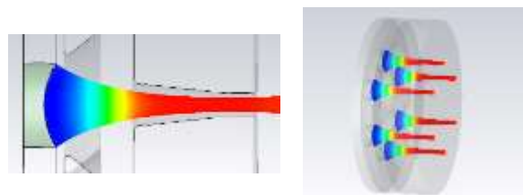
شکل (۱۰): مسیر حرکتی پرتوی الکترونی در تفنگ الکترونی
