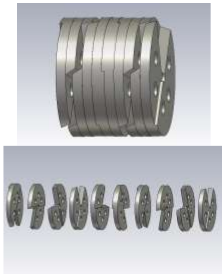
شکل (۱۴): نحوه کنار هم قرارگیری قطعات تشکیل‌دهنده ناحیه برهم کنش در راستای محوری ساختار پیشنهادی
