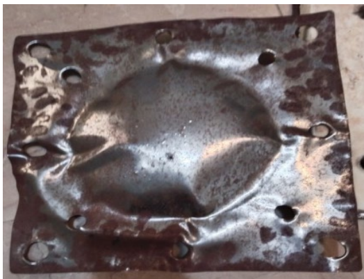
شکل ۹: نمای رویه جلویی در آزمون تجربی انفجار با هسته فومی
