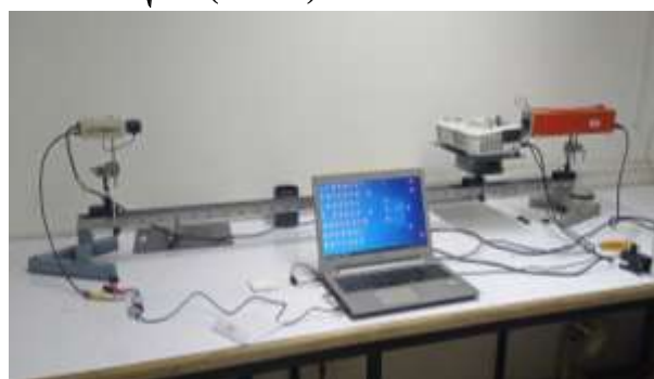
شکل ۱. چیدمان آزمایش متشکل از لیزر He-Ne و ویدئو نورافکن و دوربین CCD بر روی ریل و پایه‌های قابل تنظیم به همراه رایانه برای کنترل SLM و ضبط تصویر.
