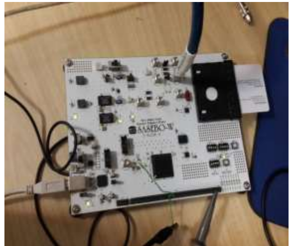
شکل (۵): نمای برد استاندارد ارزیابی حملات کانال جانبی که در این تحقیق همراه با کارت هوشمند آن مورد استفاده قرار گرفت.
