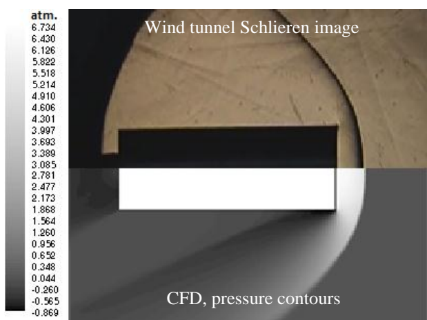
شکل (۲۲): مقایسه کانتور فشار نسبی جریان از حل عددی با تصویر شیلیرین تست تجربی در ماخ ۲/۳۵.
