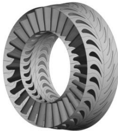
شکل (۱): هندسه طبقه چهارم توربین هانوفر.
