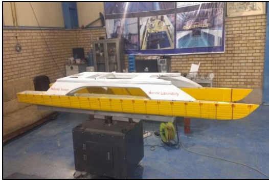
شکل (۴): مُدل نهایی کاتاماران موج‌شکن ساخته‌شده برای انجام تست و مطالعات تجربی.
