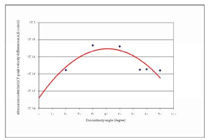
(A,B نمودار ۳- تغییرات اندیس میرایی (تفاضل سرعت ذرههای ماکزیمم در نقاط (A,B) بر حسب زاویه میل ناپیوستگی نسبت به سطح زمین
