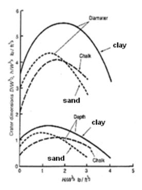
شکل ۱- رابطه بین ابعاد کراتر و عمق روباره خرج [۱ و ۲] محور افقی H/W<sup>1/3</sup> و محور قائم D/W<sup>1/3</sup>
