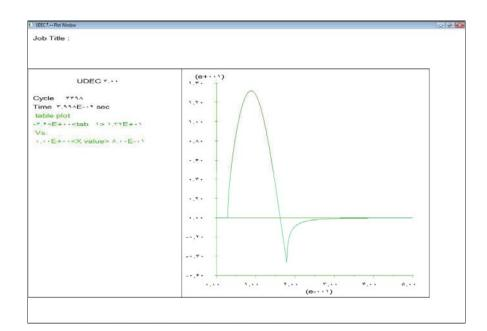
شکل ۲- شکل پالس دینامیکی ناشی از انفجار بمب که در مدلها روی سطح داخلی کراتر اعمال شده (محور قائم سرعت ذرهای بر حسب متر بر ثانیه، و محور افقی زمان بر حسب ثانیه است).
