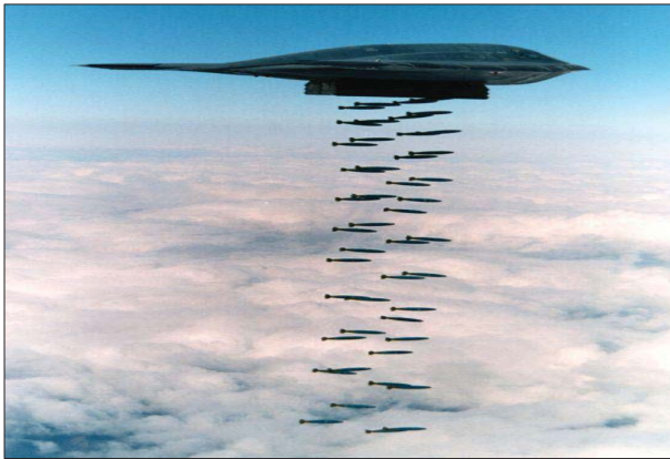
شکل ۱۱- افزایش سطح مقطع راداری به هنگام باز شدن دریچه محفظه رهاسازی سلاح.
