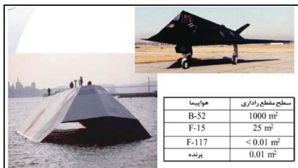
شکل ۲- تأثیر فناوری شناساگریز بر کاهش سطح مقطع راداری
