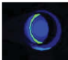
شکل ۴- عکسبرداری حرارتی از خروجی اگزوز طرح جدید (رنگ آبی نشانگر دمای پایین)
