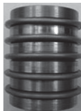
شکل ۱۳- نمونه شیاردار بعد از تست فشردگی محوری [۲۰]
