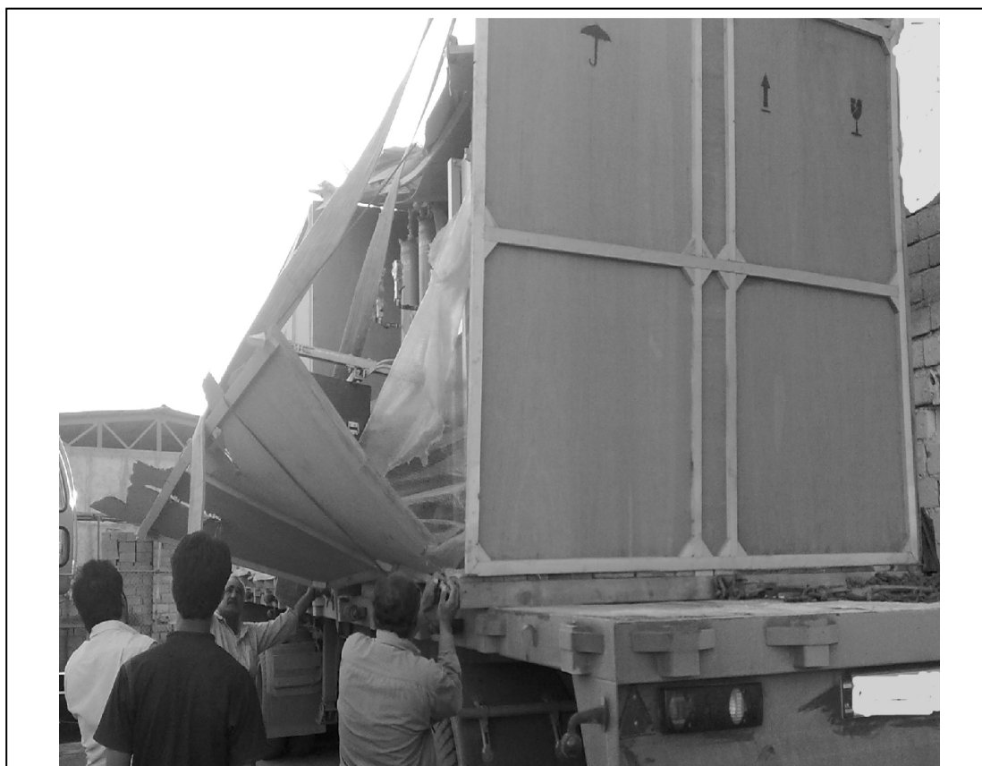
شکل ۱- آسیب به بسته و محموله در نتیجه استفاده از یک بسته بندی نامناسب (این آسیب می تواند شرایط ناامن و تهدیدات فیزیکی برای افراد را به همراه داشته باشد)
