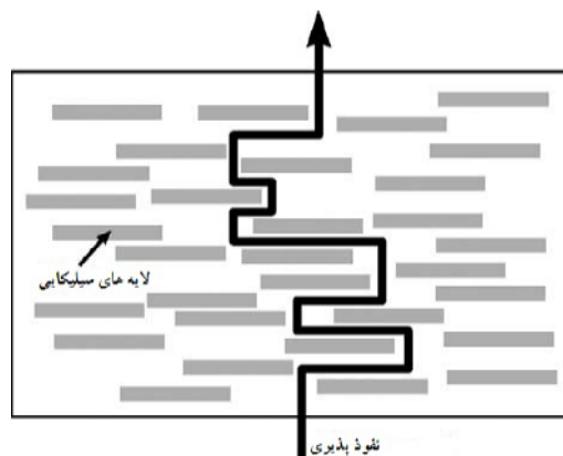
شکل ۲- مسیر نفوذ گاز و رطوبت از نانوکامپوزیت رس / پلی‌مر [۱۷]
