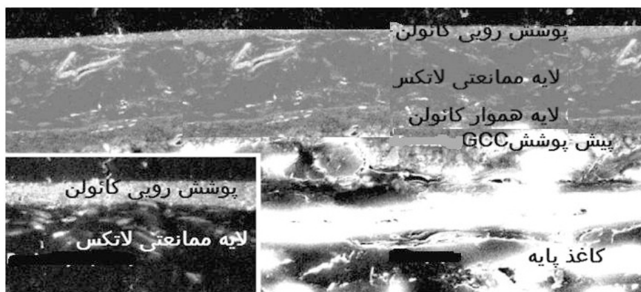
شکل ۸ - ساختار پوشش چند لایه معدنی و زیستی بر روی کاغذ
