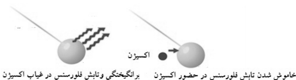
شکل ۹- نحوه برانگیختگی و خاموش شدن رنگدانه در حضور اکسیژن
