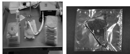
شکل ۱۰- کاربرد سنسورهای اکسیژن بر پایه فلورسنس در بسته‌بندی گوشت تازه و شناساگر آن
