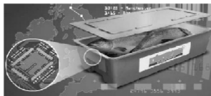
شکل ۱۲- جعبه‌های هوشمند گول بلو مجهز به سامانه‌های (RFID) برای نظارت و کنترل بر شرایط توزیع ماهی
