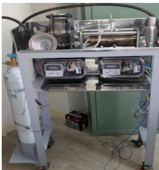
شکل (۵): مجموعه تجهیزات شکل‌دهی داغ لوله با گاز.
