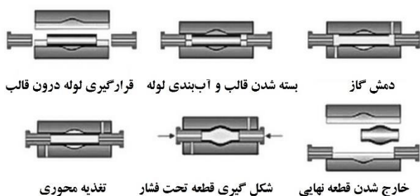
شکل (۱): فرآیند هیدروفرمینگ لوله [۱۸].
