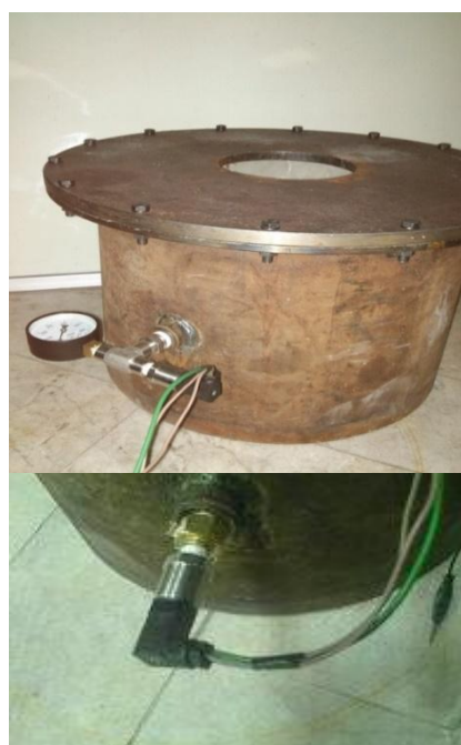
شکل (۵): مخزن ساخته شده (فشارسنج عددی در ابتدا برای کالیبراسیون دستگاه استفاده می‌شود).
