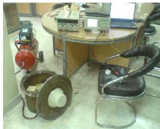
شکل (۶): مجموعه برای بارگذاری دینامیکی خارجی یک نمونه کامپوزیتی آماده شده است.
