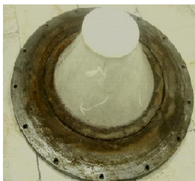
شکل (۴): نمونه مهار شده بر روی کپ بالایی مخزن (شیارها مشخص هستند).
