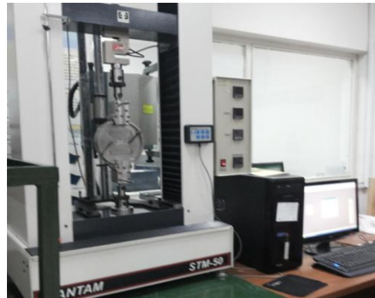
شکل (۱۶): دستگاه تست کشش و فیکسچر جدید نصب شده
