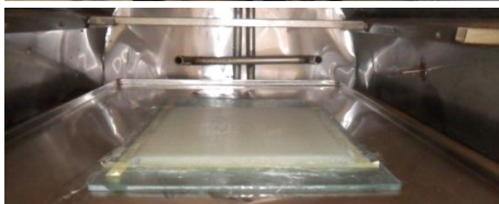
شکل (۱۳): ورق کامپوزیت بافتی ساخته‌شده و نمایی از دستگاه اتوکلاو و قرارگیری ورق در داخل آن
