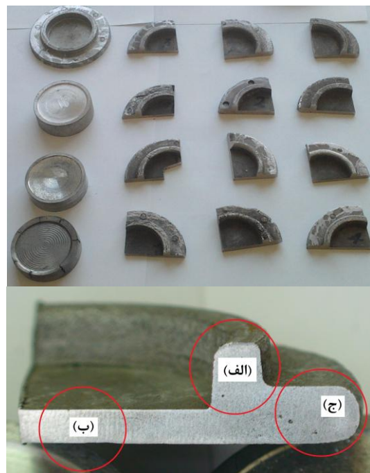
شکل (۴) برخی از نمونه‌های تولیدی و موقعیت‌های انتخابی برای مطالعه ریزساختار و سختی.
