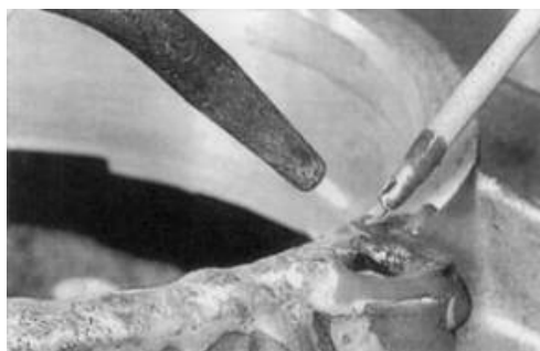
شکل ۲- قطعه آلومینیومی در حال جوشکاری گازی
