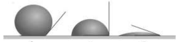
شکل ۳- نحوه قرارگیری قطره آب در حالت آب‌دوستی (الف)، آب‌گریزی (ب) و فوق آب‌گریزی در سطوح مختلف
