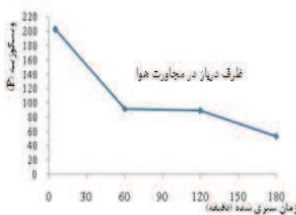
شکل ۱. تاثیر هوا بر روی گرانیروی نمونه A (محلول ۱ مولار اوکسون شامل ۱۰٪ وزنی کابوسیل)
