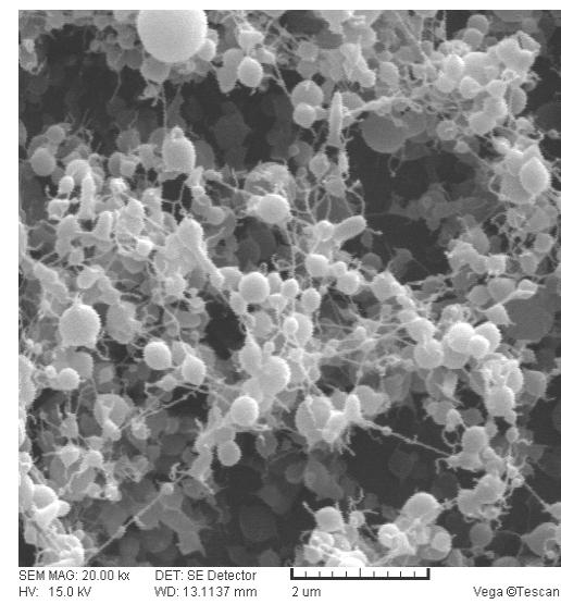
شكل ۲. تصاویر میکروسکوپ الکترونی پویشی نانو الیاف تهیه شده بر روی فویل آلمینیومی از محلول کیتوسان / پلی اتیلن اکسید و افزودنی عسل از بالا به پایین (الف)٪/۰.۳ (ب)٪/۰.۵ (ج)٪/۰.۲
