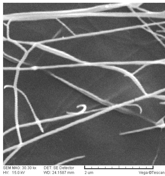
شکل ۱. تصویر میکروسکوپ الکترونی پویشی نانو الیاف تهیه شده از محلول کیتوسان / پلی اتیلن اکسید با تریتون X-100 و حلal DMSO
