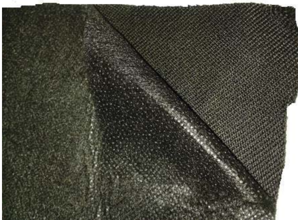
شکل ۲. پارچه کربنی لامینه شده توسط نایلون (پرلون)
