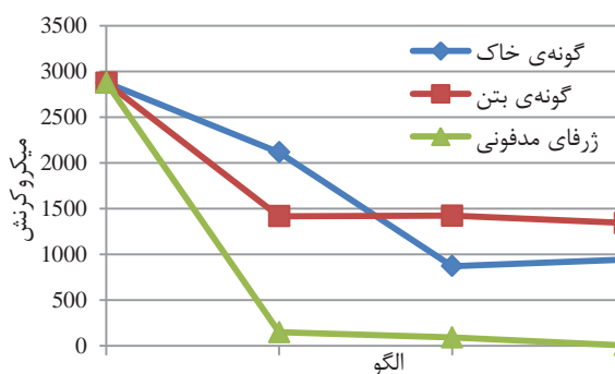
شکل ۲۰. هم‌سنجی اثر شبه‌سنجه‌های گوناگون در اندازه کرنش بیشینه پدید آمده در تاج سازه زیرزمینی و در میانه درازای سازه
