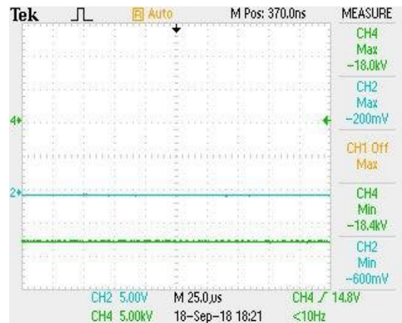
شکل (۳۳): رنگ سبز: مقدار ولتاژ باس ثانویه با پس‌رگولاتور
