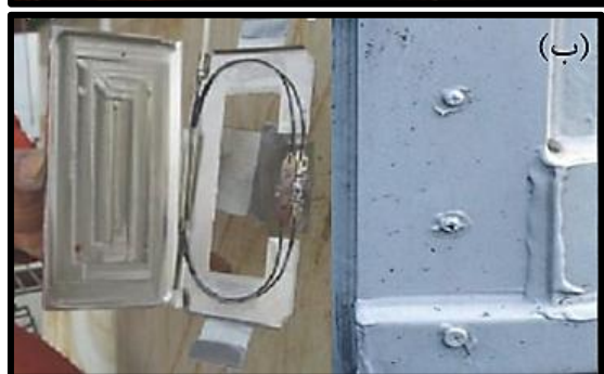
شکل (۶): استفاده از حسگر FBG برای کنترل ایمنی الف) در برج کانتون گوانزو چین. ب) جاگذاری حسگر در سازه برج [۲۷]
